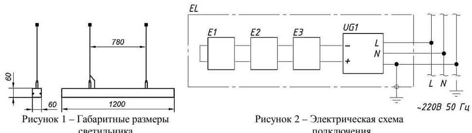
Рисунок 1 – Габаритные размеры светильника
